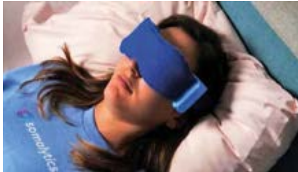
Az amerikai Somalytics maga nemében egyedülálló SomaSleep otthoni alvómaszkja a szemmozgást (a REM-fázist is) követve értékeli az alvásminőséget
