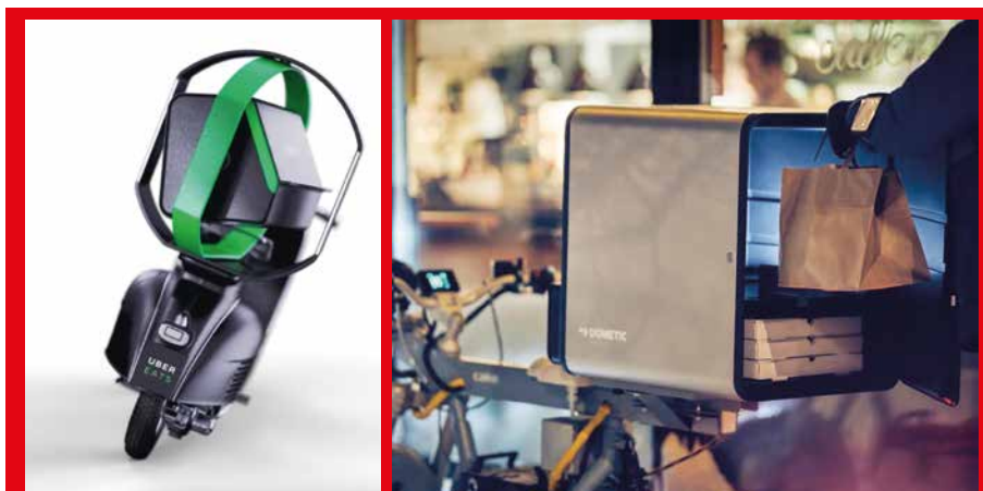
A kiszállítói verseny kulcseleme az étel minőségének megőrzése: az Uber a gyorskóp elvén működő, rázkódást akadályozó eszközt készített, a Dometic Deliboxa pedig egyszerre tartja a hideg és a meleg ételek hőmérsékletét
