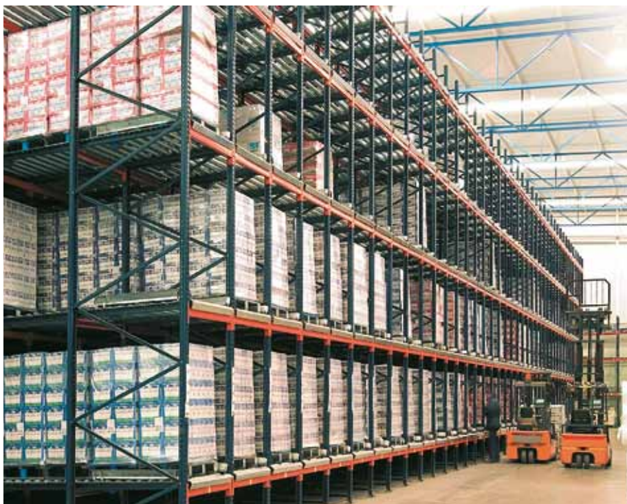
A gravitációs átgördülő állványzat a nagy forgási sebességű áruféleségekhez ajánlható
